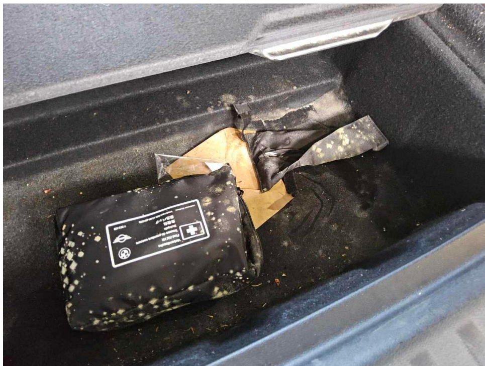
Bild 15 : Kofferraum verschmutzt, Schimmelbildung
