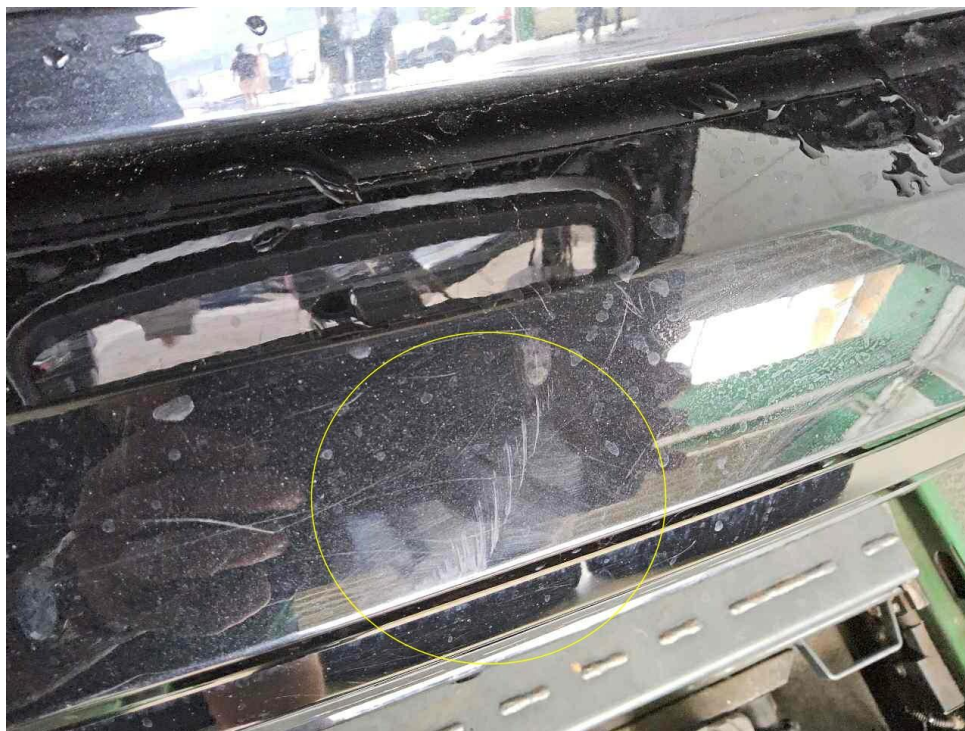
Bild 16 : Stoßfänger hinten Ladekante verkratzt
