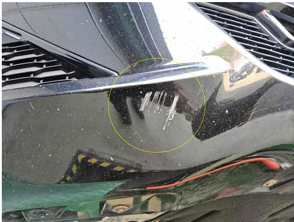
Bild 19 : Stoßfänger vorne Spoilerlippe verschrammt
