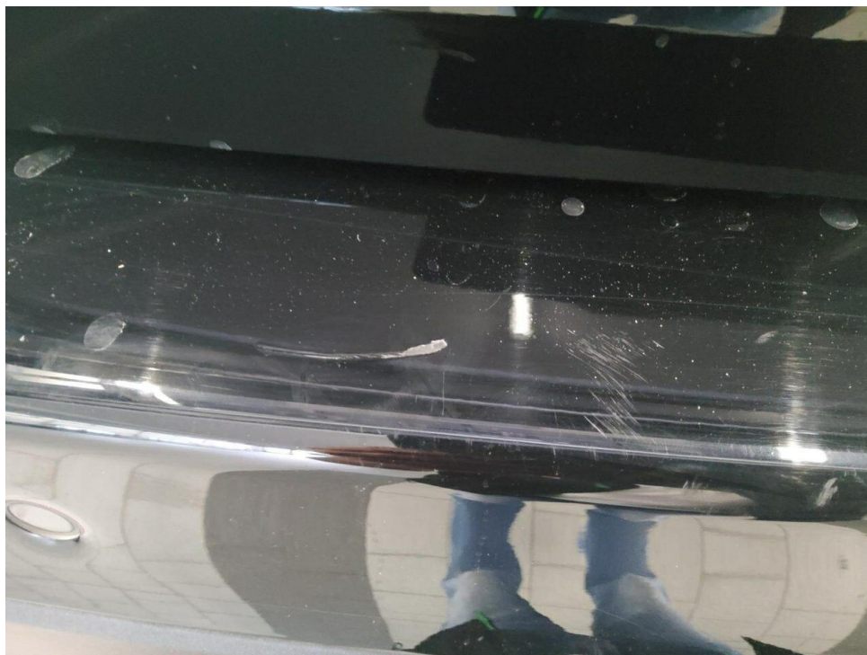
Bild 17 : Stoßfänger hinten Lackierung, verschrämmt, lackieren mit Lackaufbau
