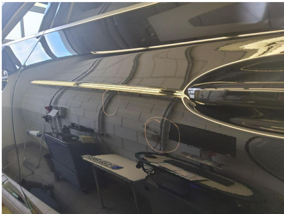
Bild 18 : Tür hinten links, deformiert, drücken
