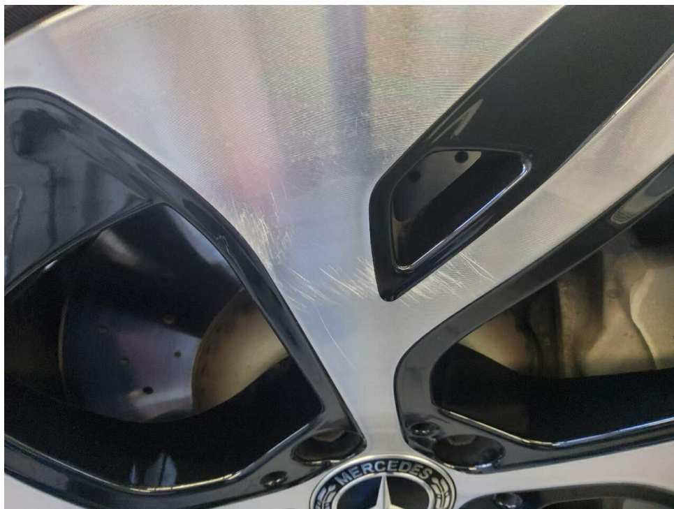
Bild 15 : Felge VL verschrammt
