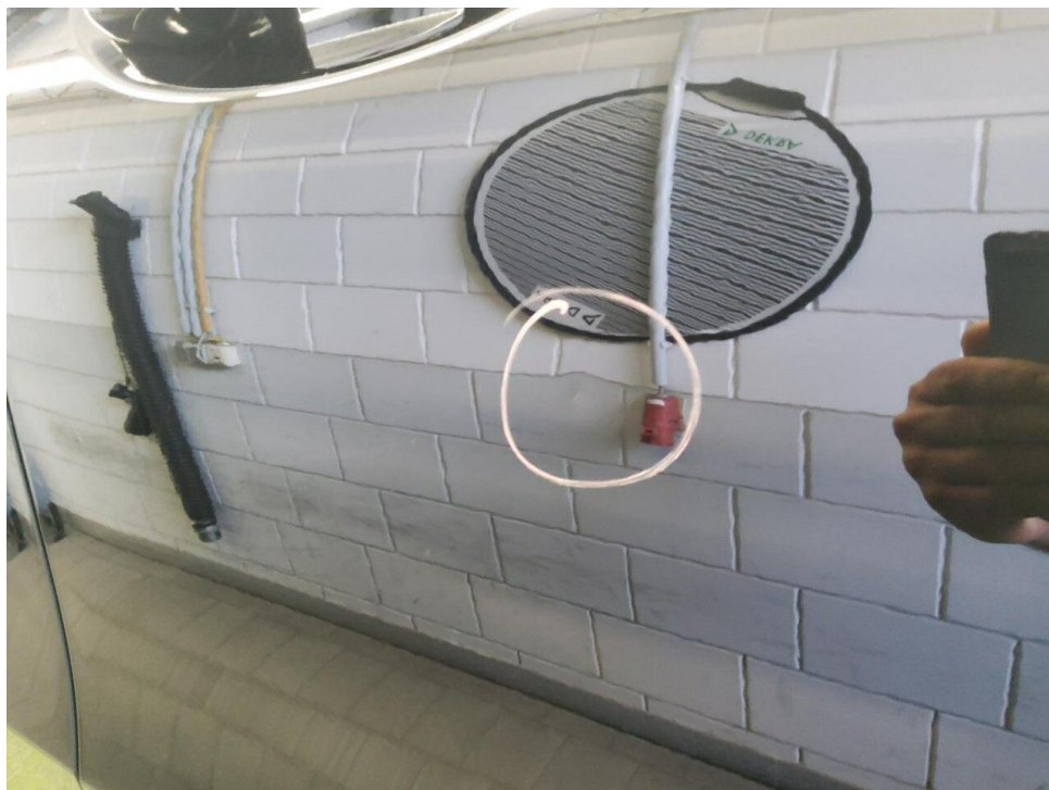
Bild 16 : Tür vorne rechts, deformiert, drücken
