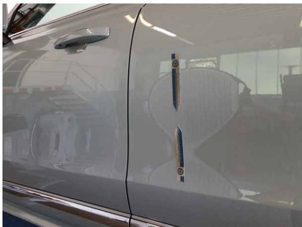
Beschädigung #2: Tür hinten links: Tür - verkratzt / verschürft - lackieren
